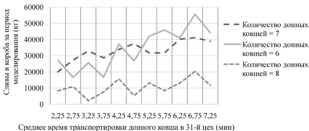
Рис. 3. Зависимость сливов в короба от совместного изменения количества и времени транспортировки донных ковшей
