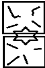
Рис. 7. Вид поперечного сечения составной балки на металлических зубчатых шпонках
