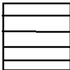
Рис. 4. Вид поперечного сечения балок, склеенных из досок
