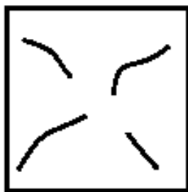
Рис. 2. Вид поперечного сечения чисто обрезанного бруса
