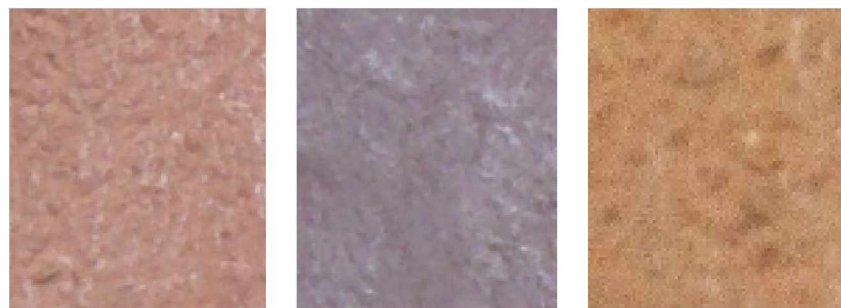
Рис. 2. Оттенки декоративного бетона – светло-коричневый, темно-коричневый, оранжевый (4% пигментирования)
