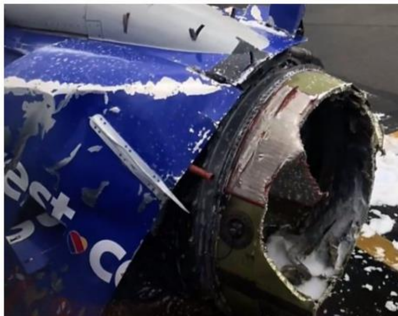
Рисунок 3 – Повреждение корпуса двигателя после отрыва лопатки турбины.
