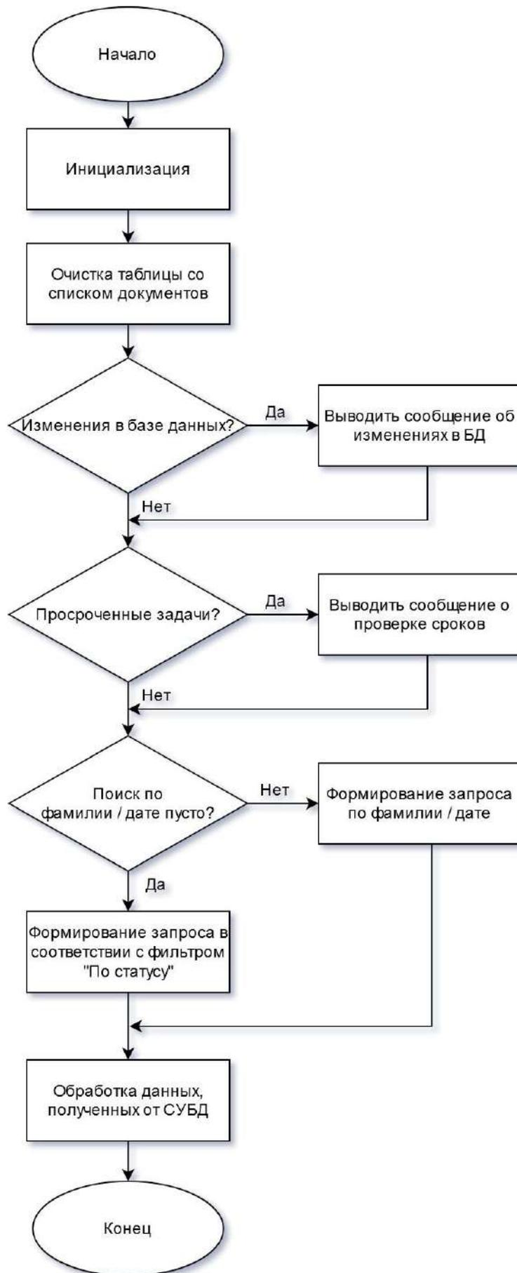
Рисунок 6.7 – Блок-схема алгоритма основного цикла программы
