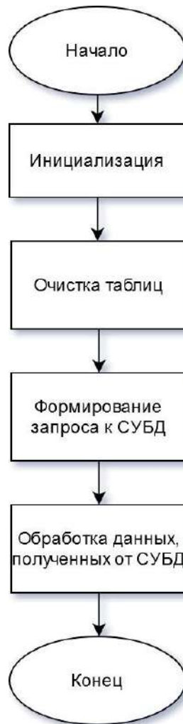
Рисунок 4.4 – Блок-схема алгоритма работы программы для окна поиска
