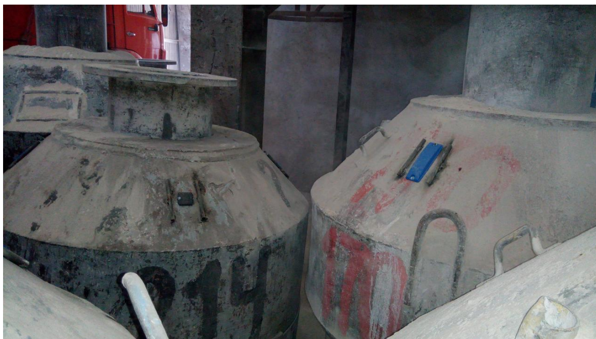
Рис. 2. Варианты крепления радиометок на металлическую тару
