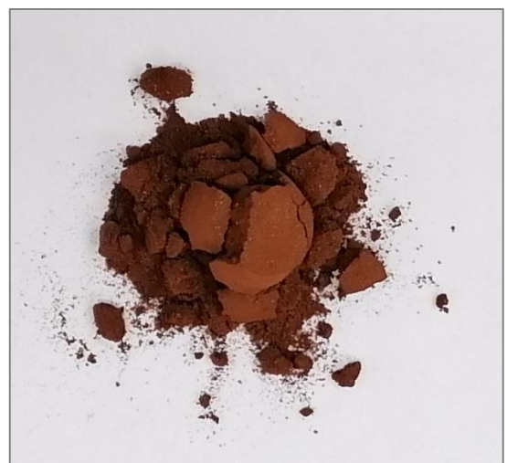
Рисунок 3е – Внешний вид образца после ферритизации
