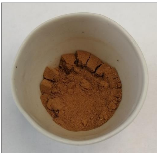
Рисунок 3д – Внешний вид образца после окисления остаточного углерода
