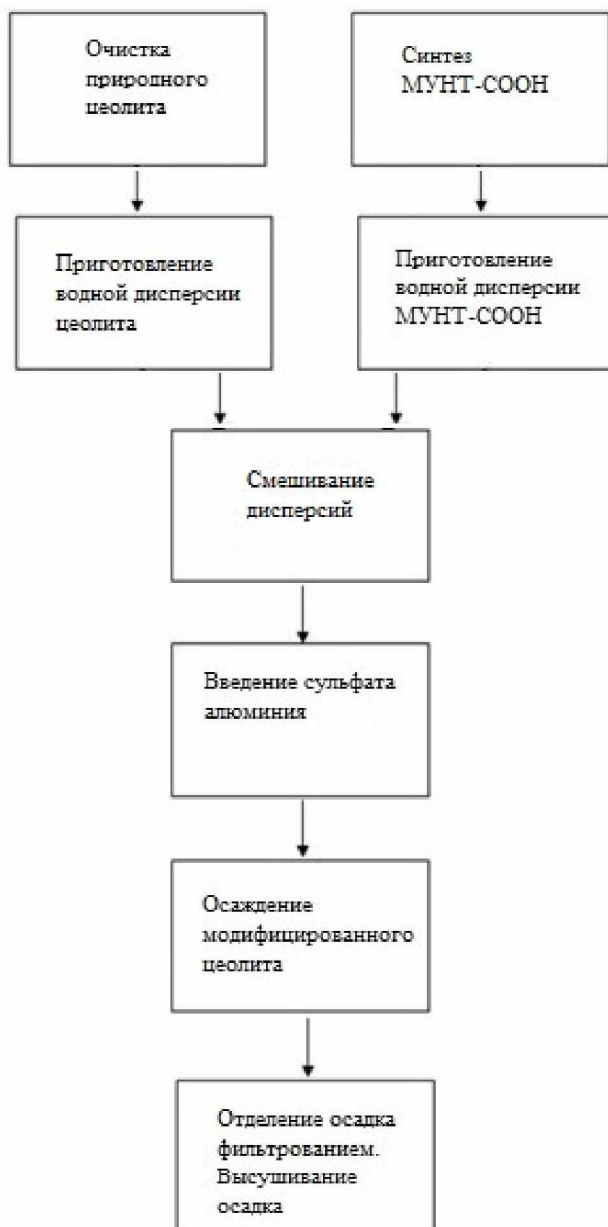
Рис. 3. Технологическая схема получения сорбционного материала на основе природного цеолита и МУНТ
