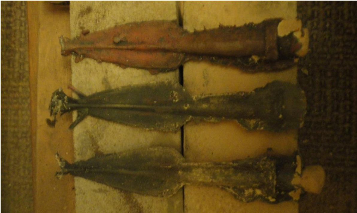
Рис. 2. Эксперименты по заливке бронзовых наконечников копий
