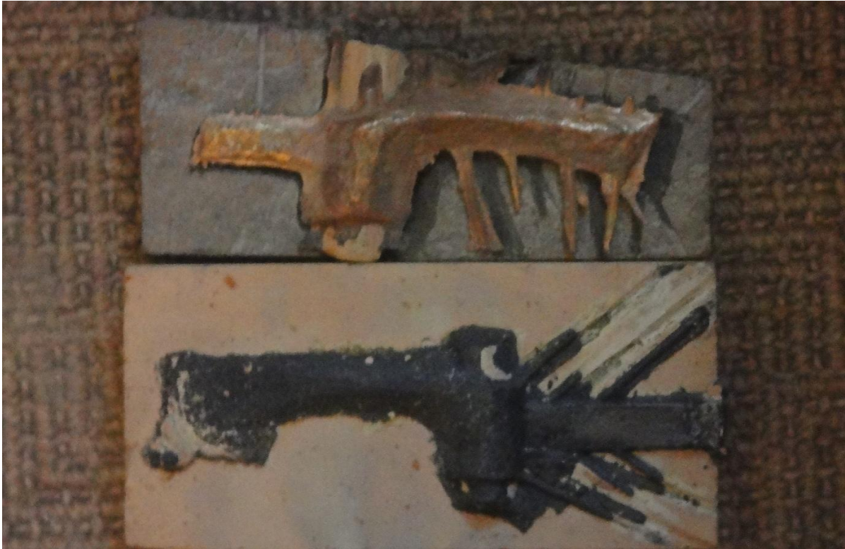
Рис. 3. Эксперименты по отливке бронзовых топоров в глиняную и каменную формы
