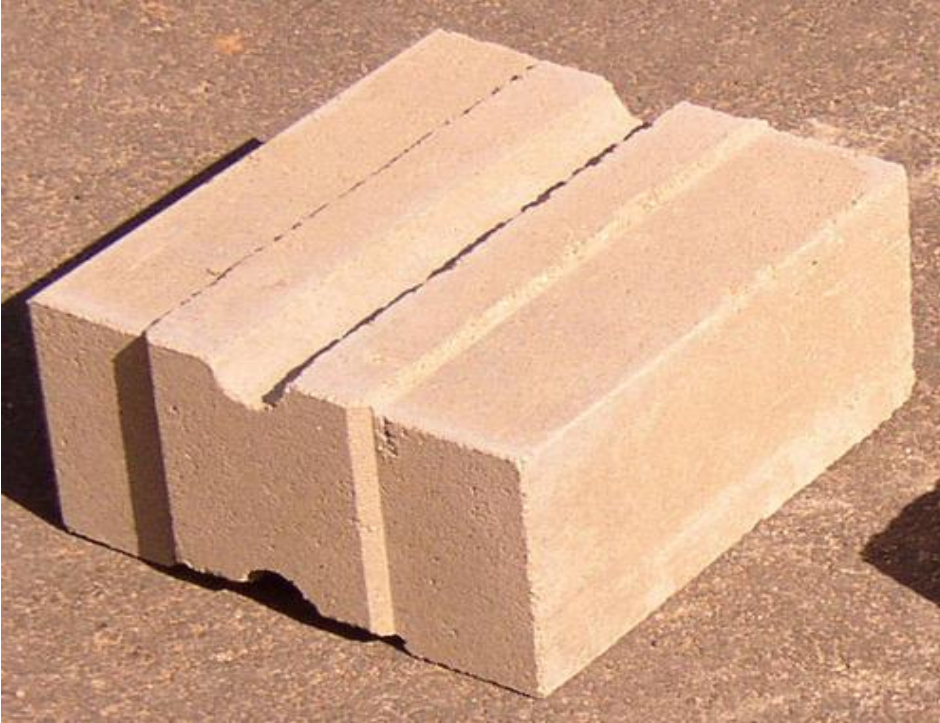
Рис 3.9: Почвенные блочного стабилизационных с известью и летучей золой
