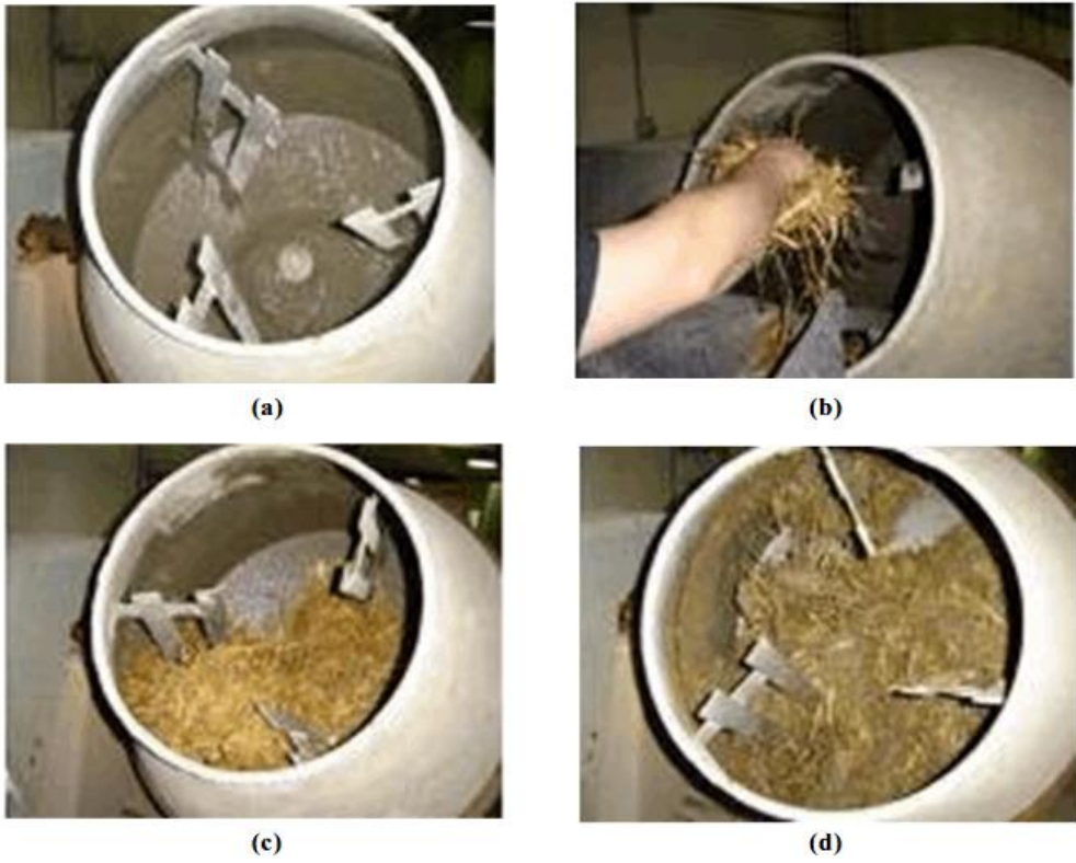
Рис 2.4.13: Механическое перемешивание в бетономешалке: (а) приготовление суспензии (б) добавление обработанной соломы (с) начало перемешивания (д) окончание перемешивания.
