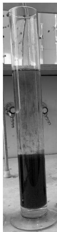
Рисунок 4.5 – Цилиндр №3 после 30 минут отстаивания
