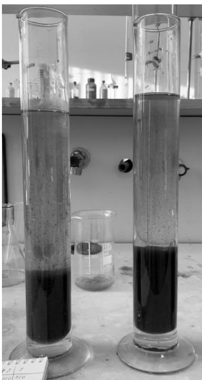
Рисунок 4.4 – Цилиндры №1 и №2 после 30 минут отстаивания
