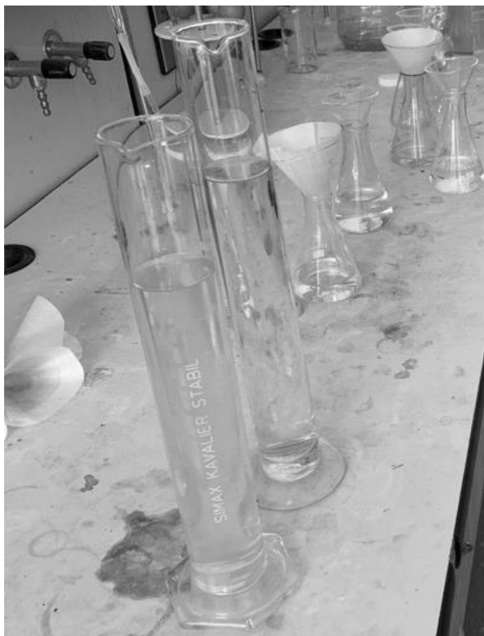
Рисунок 3.4 – Цилиндры объемом 0,5 литров с фильтрованной и нефилтрованной водой
