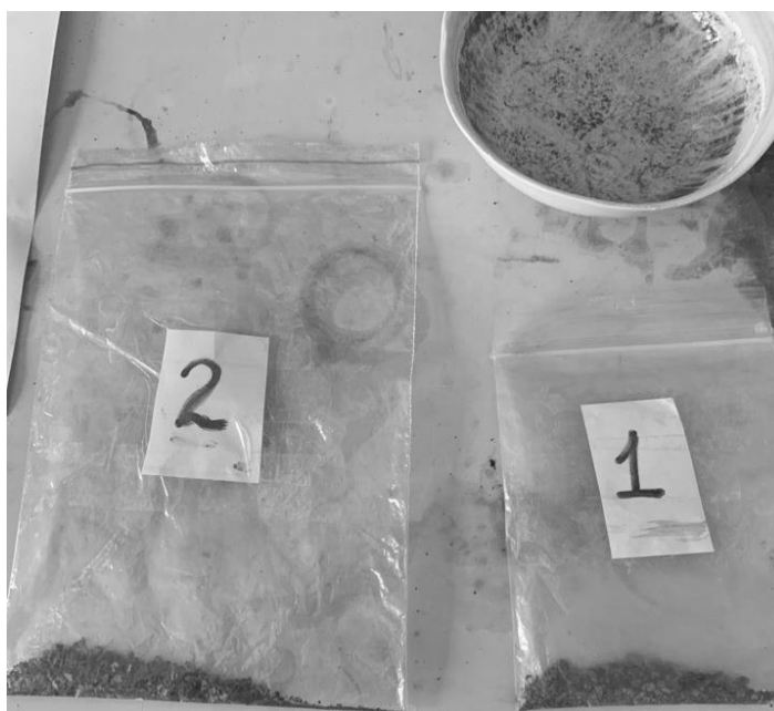
Рисунок 6.7 – Осадок после пропекания подготовленный для рентгенографического исследования
