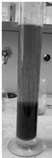
Рисунок 4.1 – Цилиндр №1 после введения известкового молока
