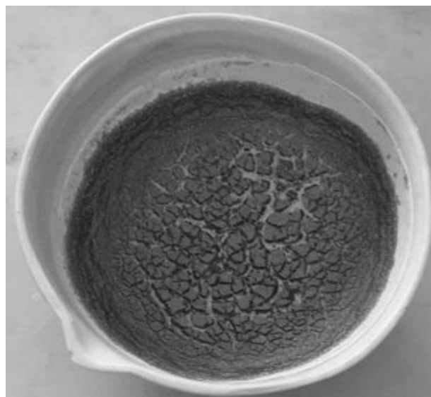
Рисунок 6.6 – Осадок после просушивания в печи (известково-глинистая пыль)
