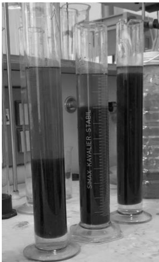
Рисунок 4.9 – Цилиндры № 7, № 8 и № 9 с испытуемой водой после введения известково-глинистой пыли
