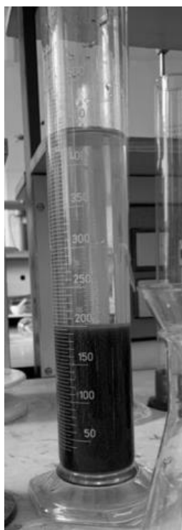
Рисунок 4.12 – Цилиндр № 6 спустя 5 минут после введения дополнительной дозы реагента
