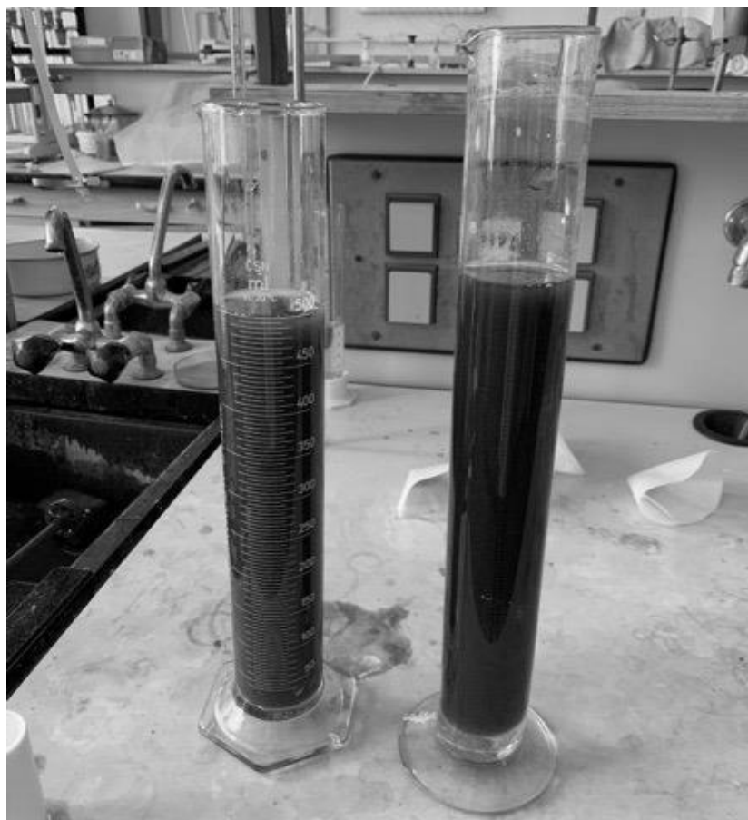
Рисунок 3.7 – Цилиндры №1 и № 2 после добавления дополнительной дозы известкового молока
