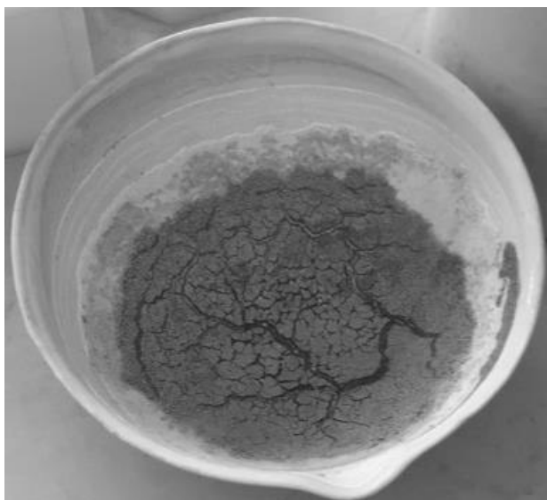
Рисунок 6.5 – Осадок после просушивания в печи (известковое молоко)
