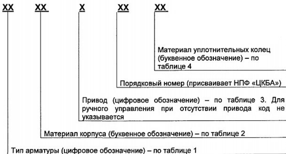
Рис. 3.7– Расшифровка маркировки запорной арматуры согласно ГОСТ
