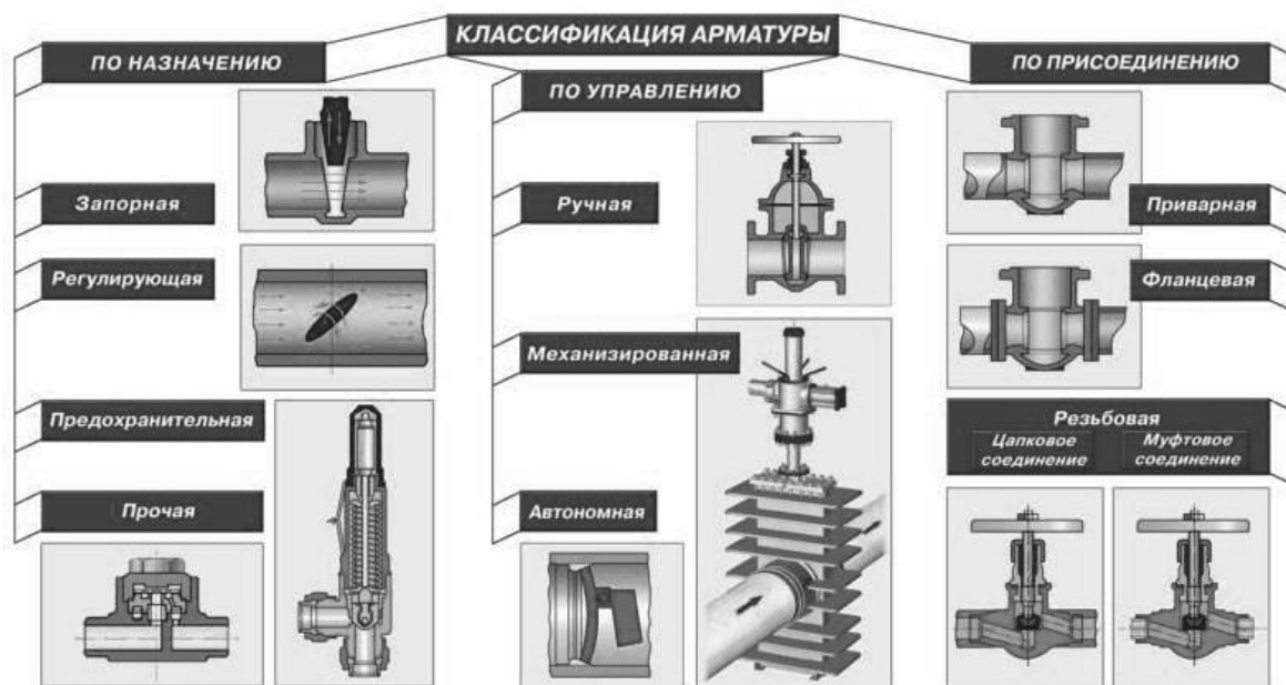
Рис. 3.6 – Основная классификация трубопроводной арматуры
