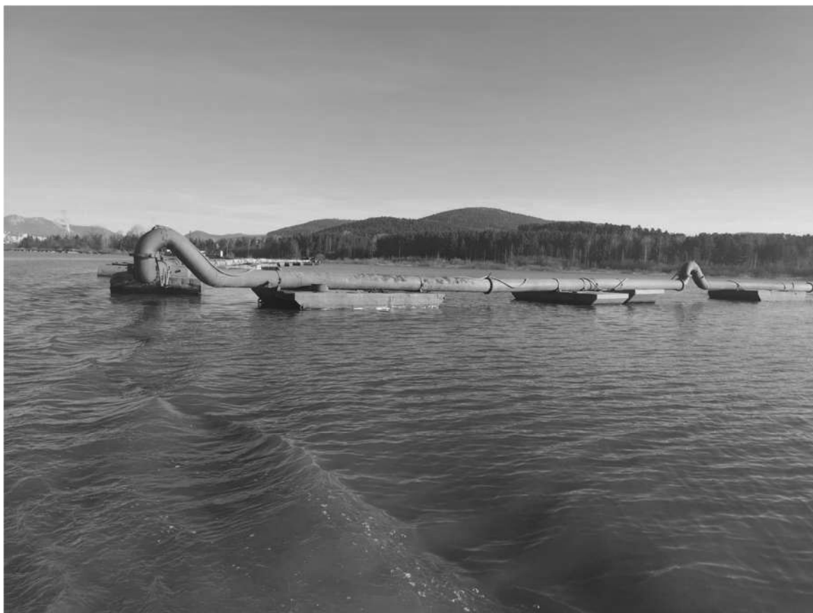
Рисунок 25 – Плавающий пульпопровод с поплавками
