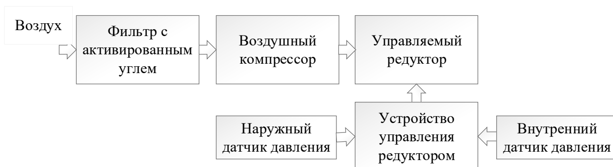
Рисунок 26 – Схема очистки воздуха в помещении от радона
