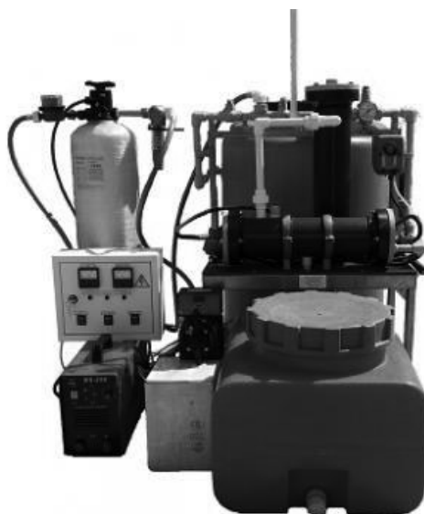
Рисунок 39 – Схема работы электролизной установки ECOFLOW для получения гипохлорита натрия
