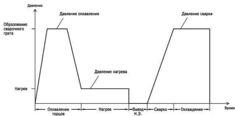
Рисунок 9 – Циклограмма процесса сварки встык нагретым инструментом.
