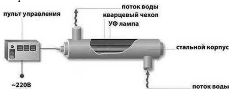
Рисунок 9 – Схема подключения ультрафиолетового фильтра для воды
