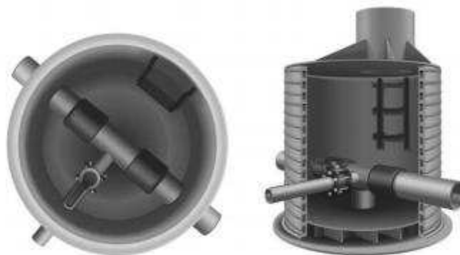
Рисунок 2.3 – Полиэтиленовый колодец для напорных сетей
