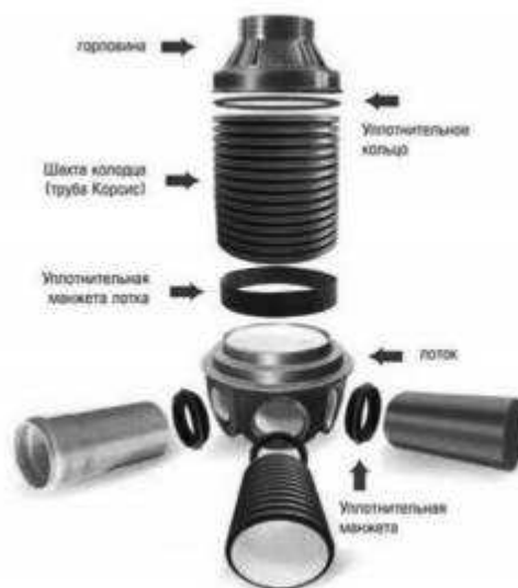
Рисунок 2.5 – Составляющие водопроводного колодца
