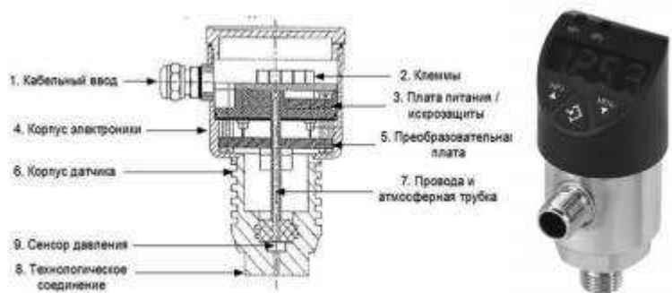
Рисунок 2.9– Схема и внешний вид преобразователя давления
