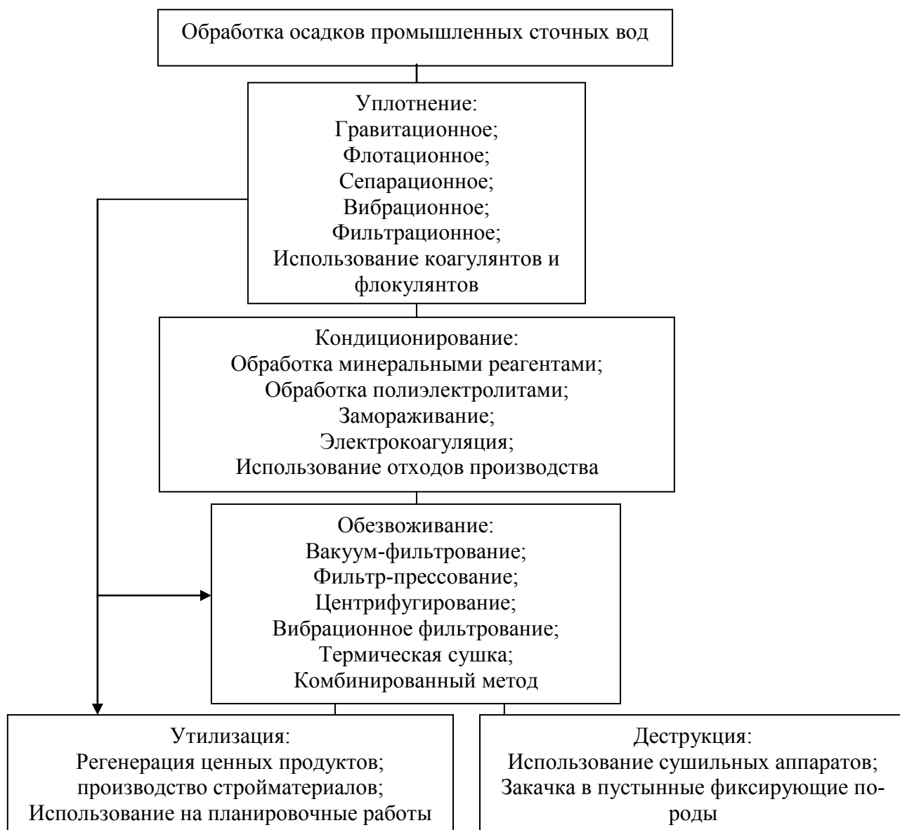
Рисунок 6 – Основные методы обезвоживания и утилизации осадков промышленных сточных вод
