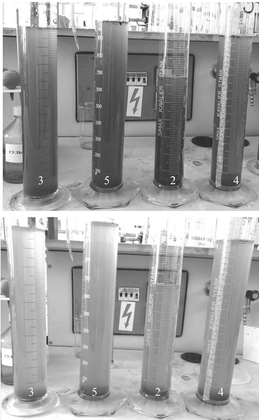
Рисунок 10 – Процесс отстаивания талой воды ( t=0 и t=24 часа)
