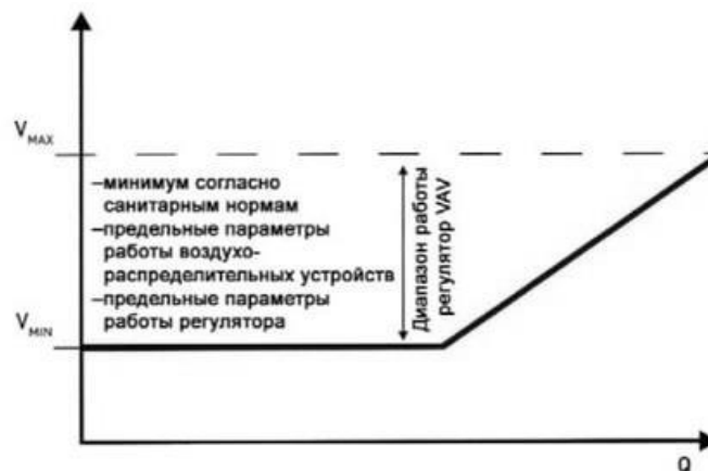
Рис. 3.1.1 Ограничение минимальной величины расхода воздуха, поступающего через терминалы VAV. На графике показано изменение величины расхода как функции тепловой нагрузки помещения, определяющей значения V_{MAX} и V_{MIN}
