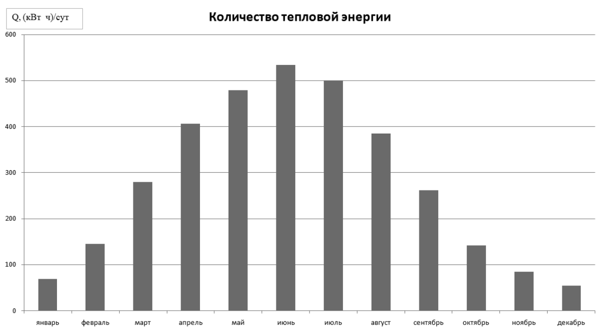
Рисунок 4.2 – Количество тепловой энергии, вырабатываемой солнечными коллекторами Viessmann Vitosol SP3C
