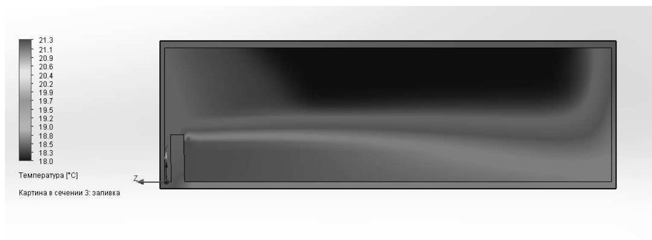
Рисунок 4.13 – Распределение температуры воздушной струи в помещении.
