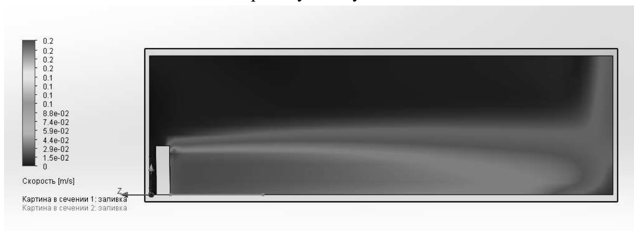
Рисунок 4.10 – Распределение скоростей по комнате при подаче воздуха в рабочую зону
