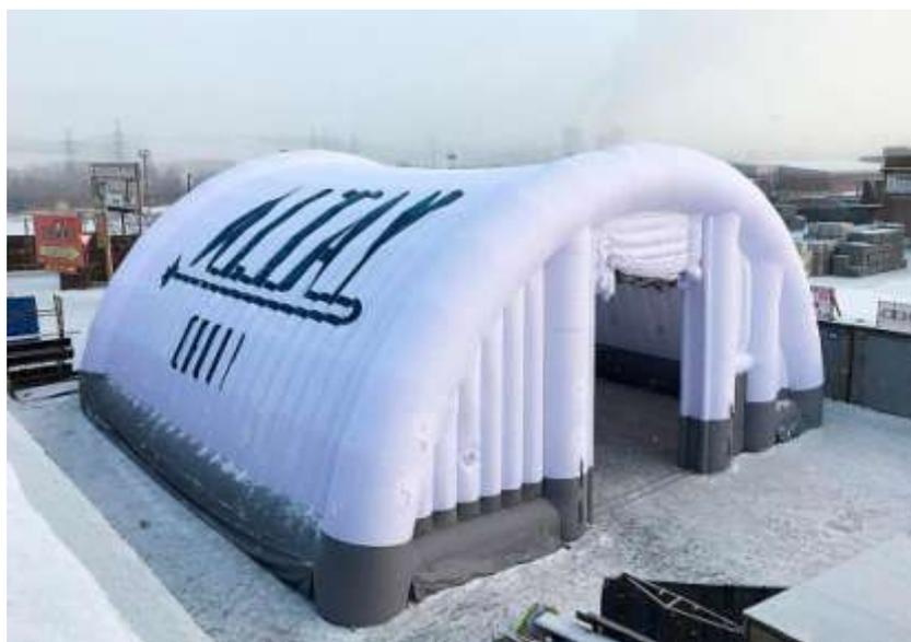
Рисунок 1.4.4 – Пневмокаркасное быстровозводимое сооружения
