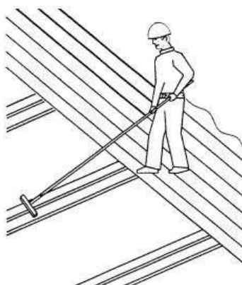
Рис. 4.1.2.6. Очистка балок перекрытия
