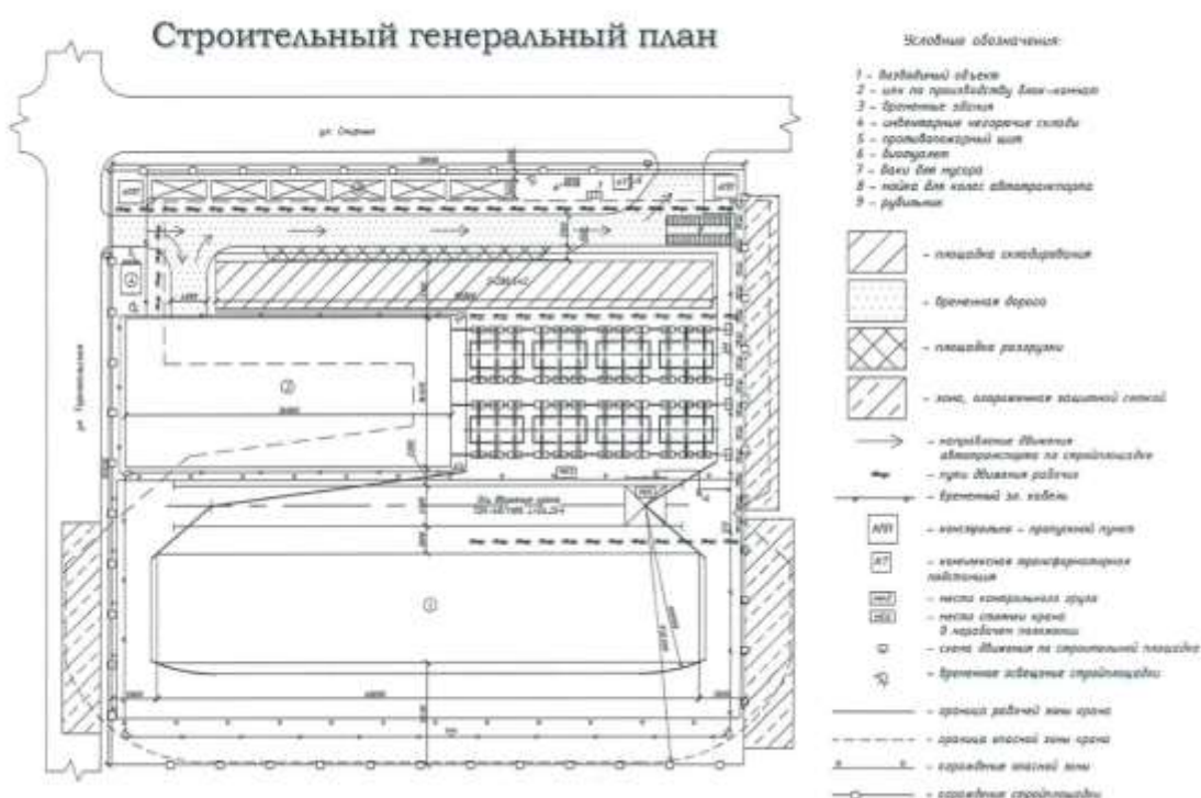
Рис.36 Строительный генеральный план с мобильным цехом
