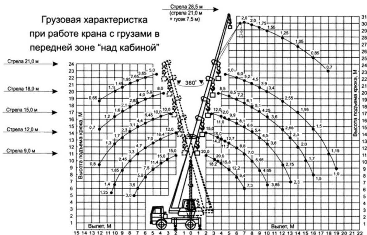
Рис. 4.2 - Грузовысотные характеристики крана
