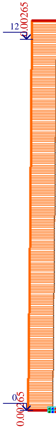
Рис. 14 Эпюры поперечной силы в колонне Q (т)
