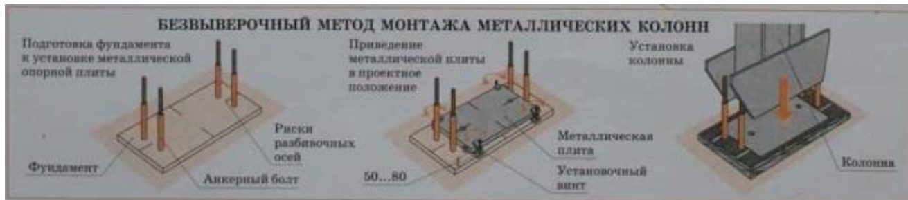
Рис.22 .Безвыверочный монтаж стальных колонн
