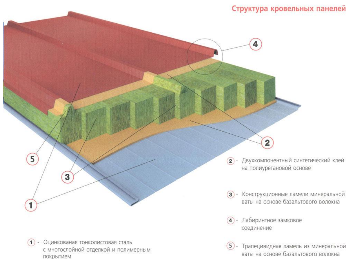
Рис. 4.9. Структура кровельных панелей.
