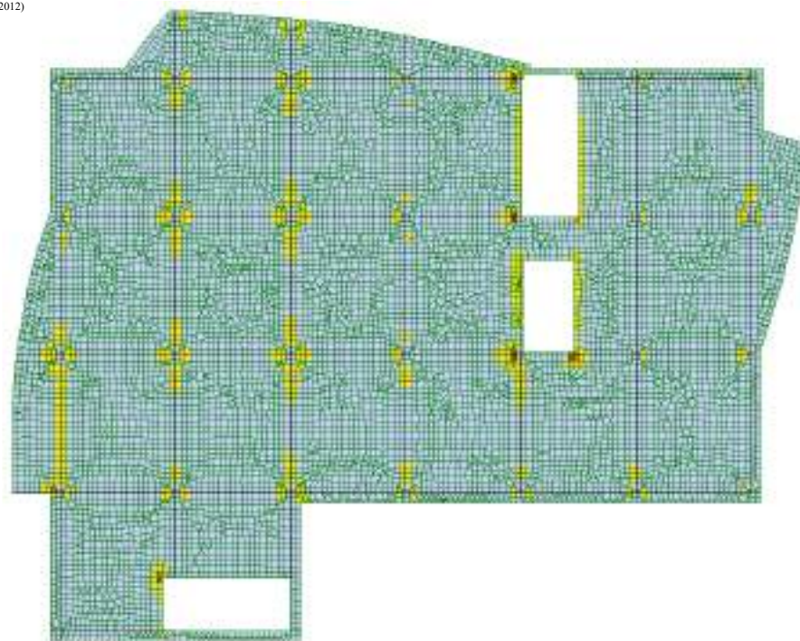
Рис. 3.17 Мозаика армирования верхней арматуры вдоль б.о.
