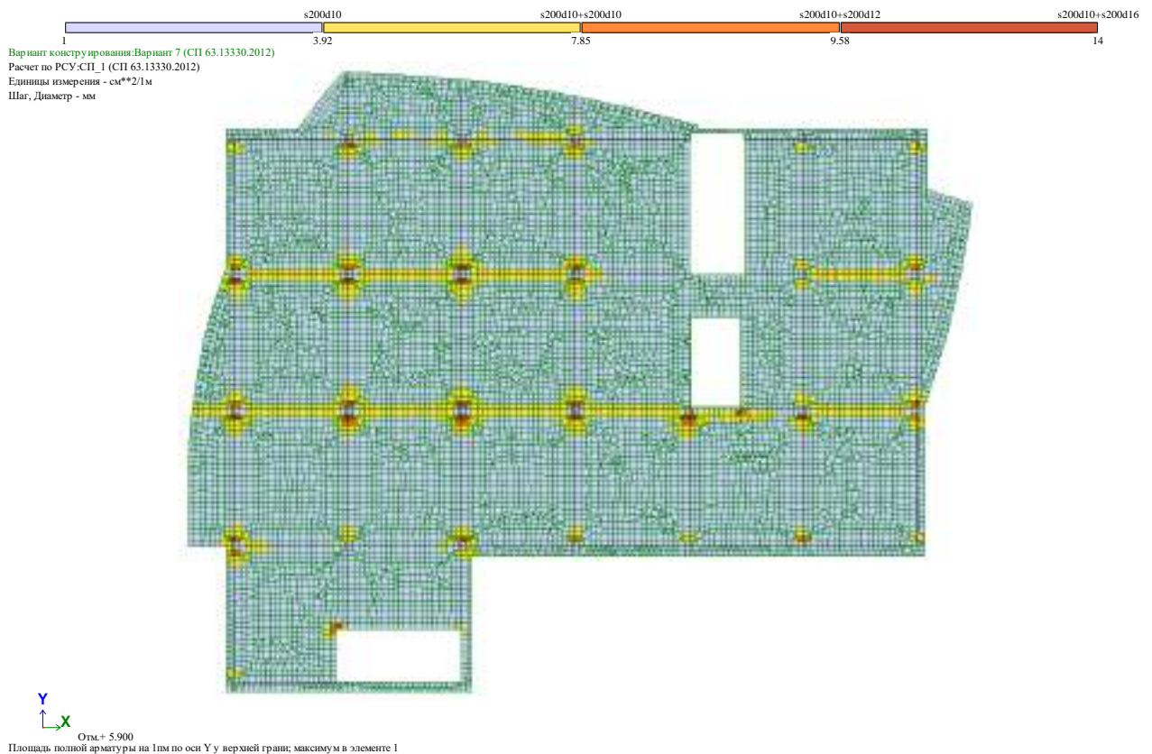
Рис. 3.18 Мозаика армирования верхней арматуры вдоль ц.о.
