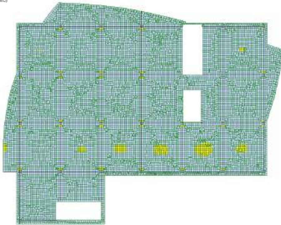
Рис. 3.16 Мозаика армирования нижней арматуры вдоль ц.о.
