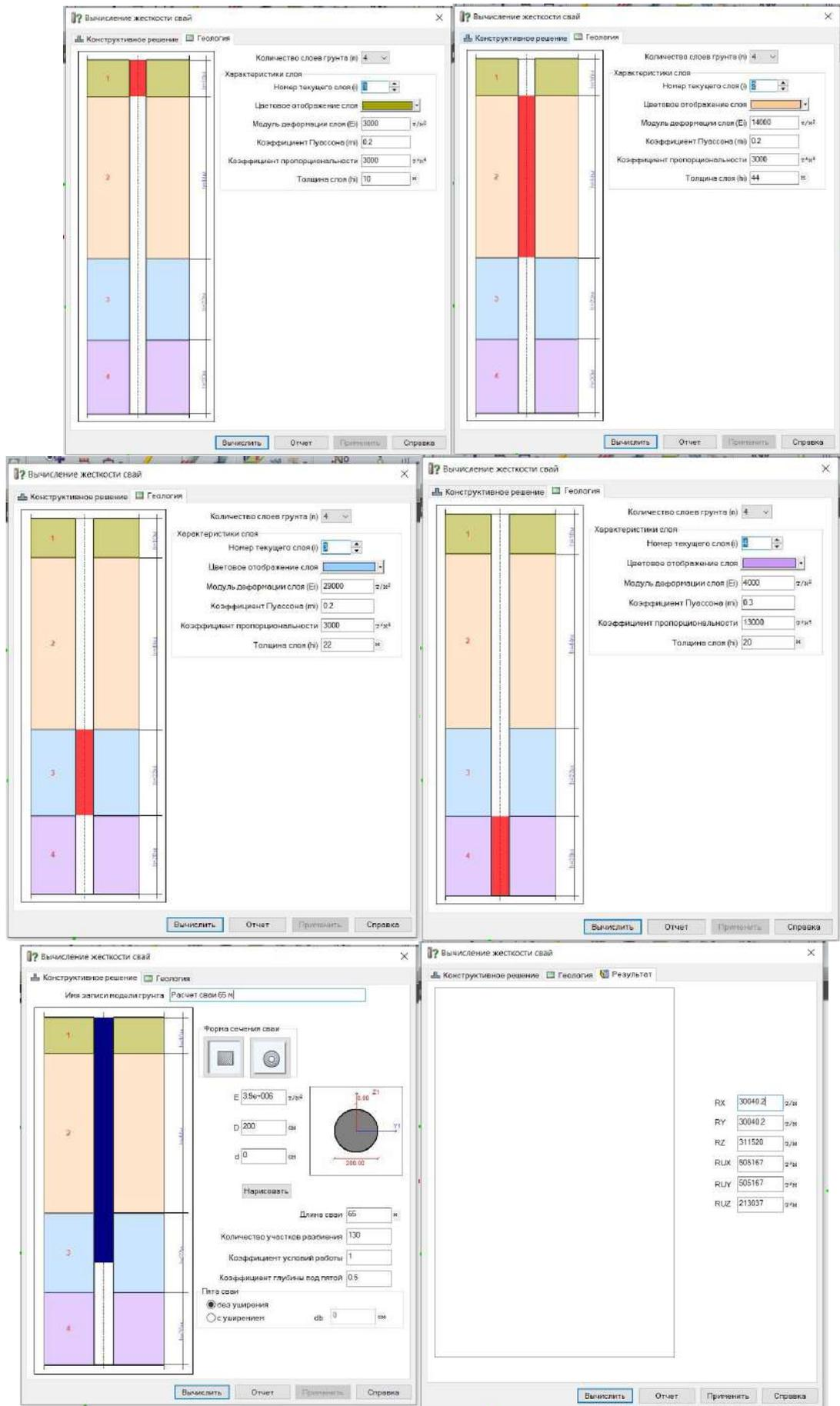
Рисунок 14 – Вычисление жёсткостей свай длиной 65м
