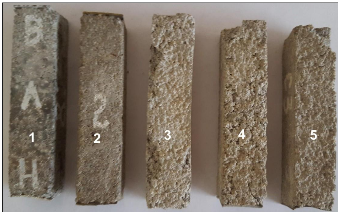
Рисунок 3.16 – Образцы бетона состава Г4 (1), М4(2) и без добавок (3, 4 и 5) после 150 сут пребывания в растворе сульфата натрия
