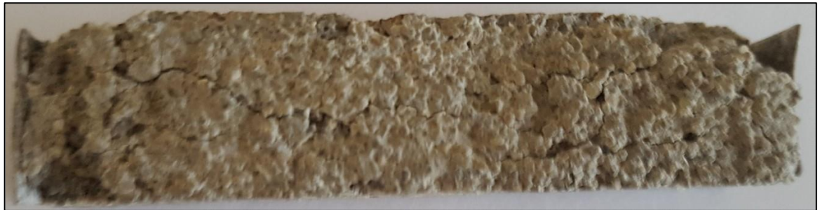
Рисунок 3.14 – Образцы бездобавочного бетона после 150 сут испытаний на стойкость к воздействию сульфатной агрессии
