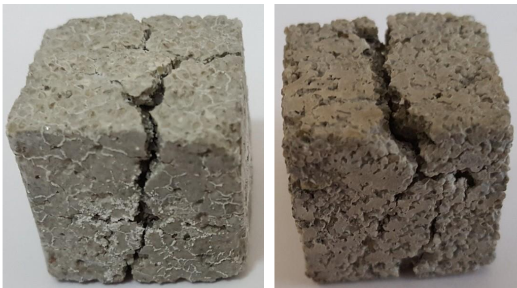
Рисунок 3.9 – Характер разрушения мелкозернистого бетона состава М4 в результате попеременного замораживания и оттаивания после 300 циклов
