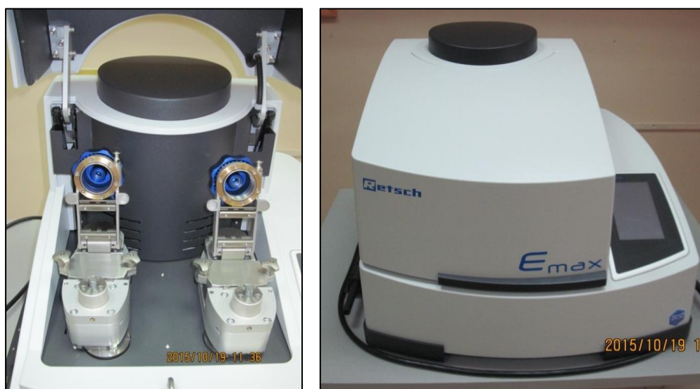
Рисунок 2.1 – Высокоскоростная шаровая мельница Emax
