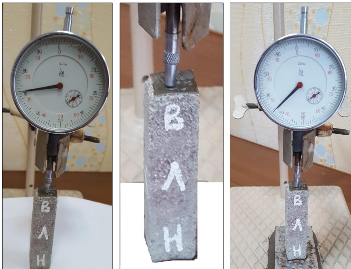
Рисунок 2.5 – Определение деформаций набухания образцов
