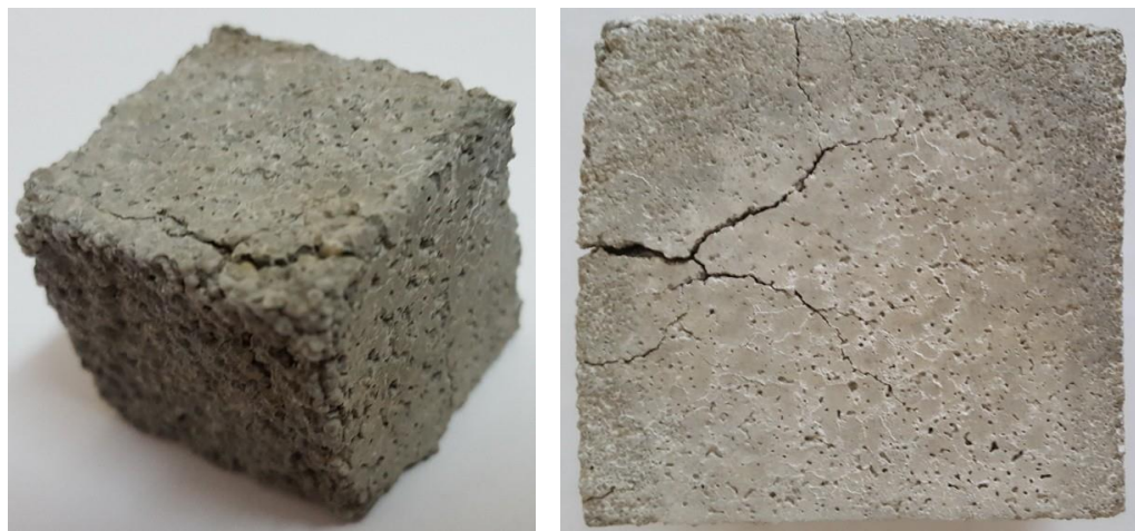
Рисунок 3.10 – Характер разрушения мелкозернистого бетона состава Г4 в результате попеременного замораживания и оттаивания после 350 циклов
