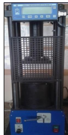
Рисунок 2.4 – Гидравлический прес ПГМ –500МГ4А
