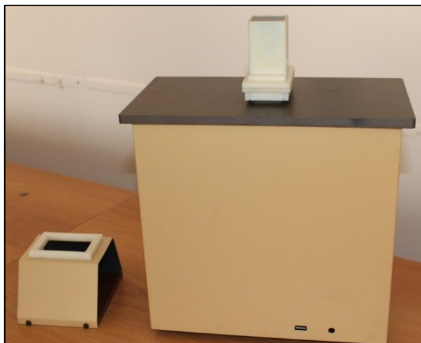
Рисунок 2.2 – Фотометрический седиментометр ФСХ – 6К
