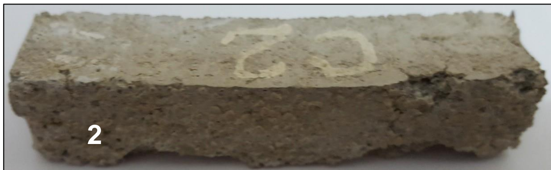
Рисунок 3.15 – Образцы бетона состава С4 после 150 сут (1) и 180 сут (2)
