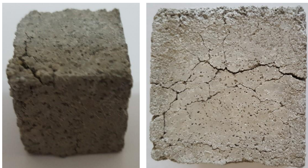
Рисунок 3.10 – Характер разрушения мелкозернистого бетона состава Г4 в результате попеременного замораживания и оттаивания после 350 циклов
