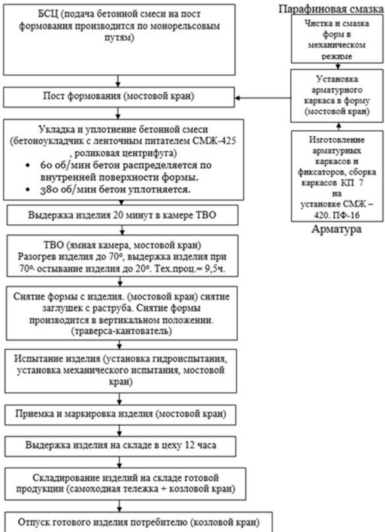
Рисунок 13 – Схема производства железобетонных безнапорных труб
