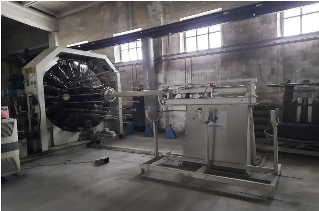
Рисунок 10 –Станок для сварки замкнутых каркасов
