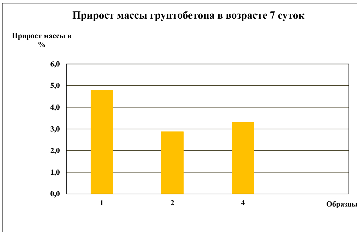
График 6 – прирост массы грунтобетона в возрасте 7 суток после испытаний на водопоглощение.
