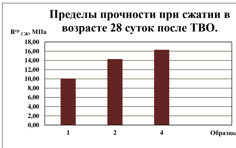
График 3 – зависимость предела прочности от составов образцов в возрасте 28 суток после ТВО.
