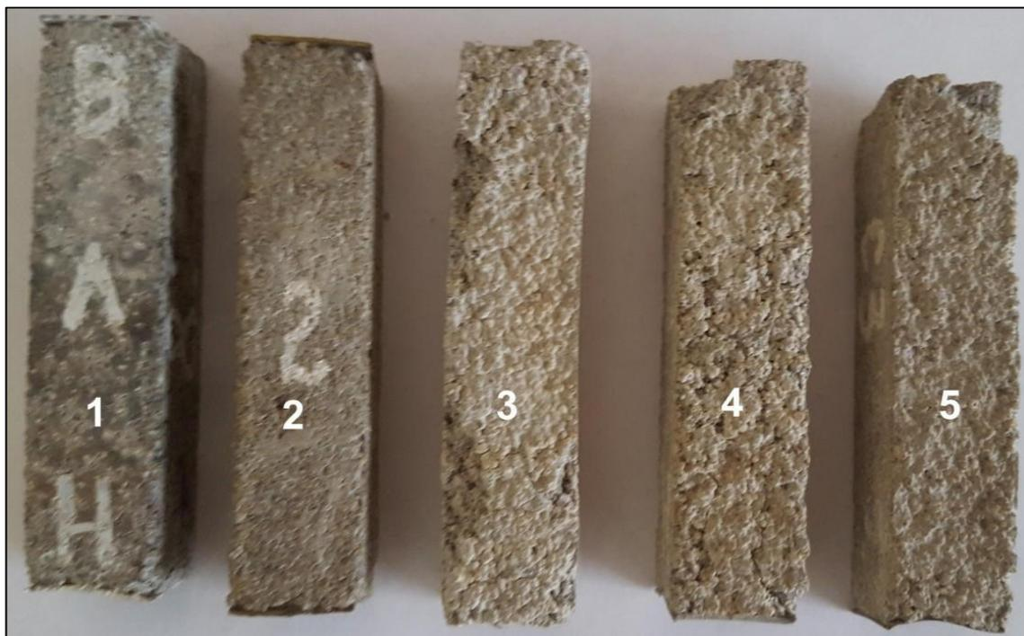
Рисунок 3.16 – Образцы бетона состава Г4 (1), М4(2) и без добавок (3, 4 и 5) после 150 сут пребывания в растворе сульфата натрия
