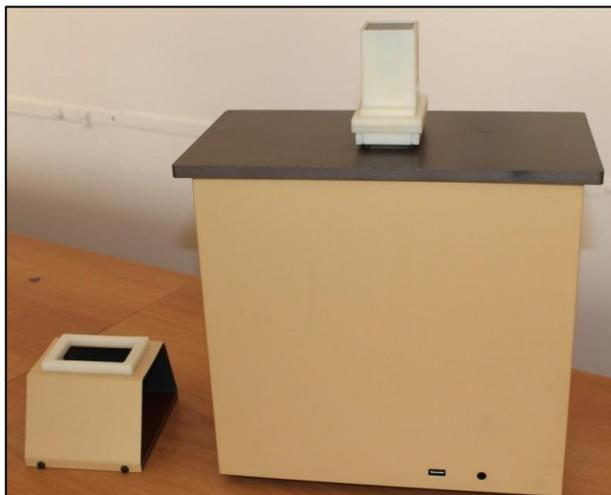
Рисунок 2.2 – Фотометрический седиментометр ФСХ – 6К
