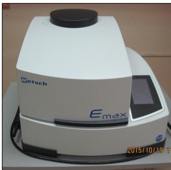
Рисунок 2.1 – Высокоскоростная шаровая мельница Emax
