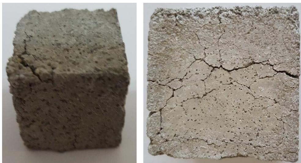
Рисунок 3.11 – Характер разрушения мелкозернистого бетона состава Г7 в результате попеременного замораживания и оттаивания после 350 циклов
