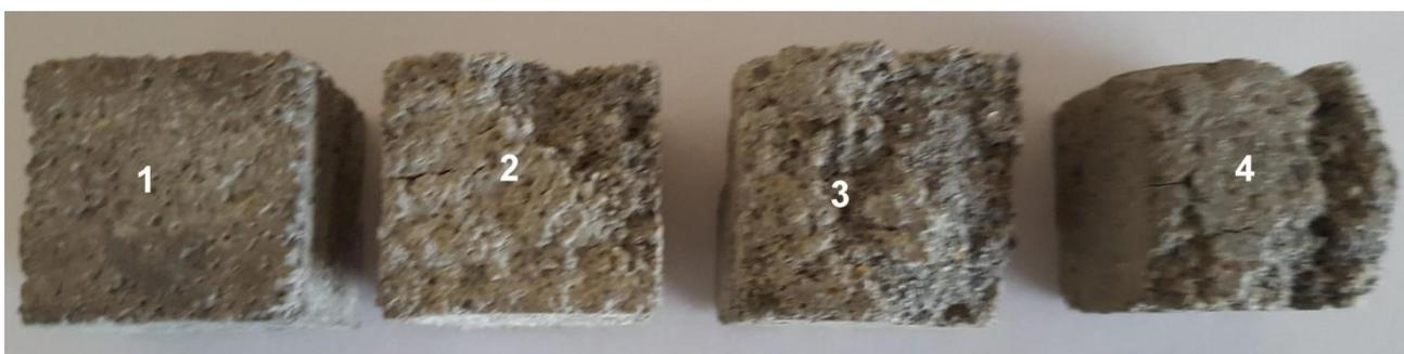
Рисунок 3.8 – Характер разрушения мелкозернистого бетона состава С4 в результате попеременного замораживания и оттаивания после 200 (1), 250 (2, 3 и 4) циклов
