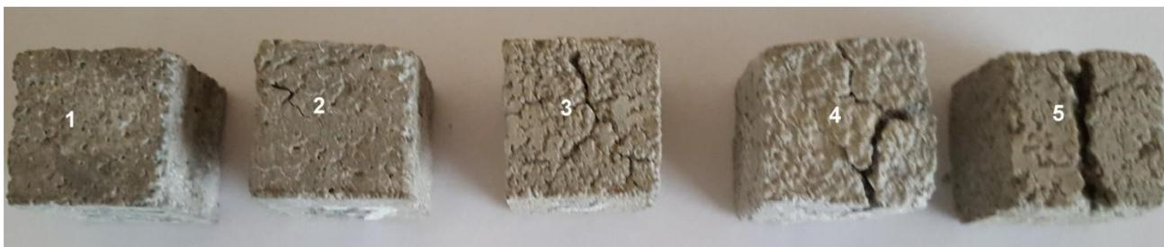
Рисунок 3.7 – Эволюция разрушения бездобавочного мелкозернистого бетона в результате попеременного замораживания и оттаивания после 100 (1), 150 (2), 200 (3, 4 и 5) циклов
