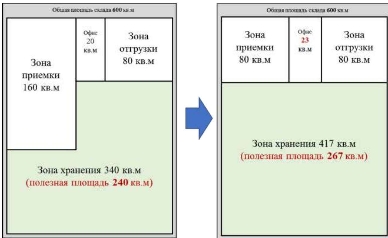
Рисунок 3.6 – Зонирование пространства склада до и после реконструкции
