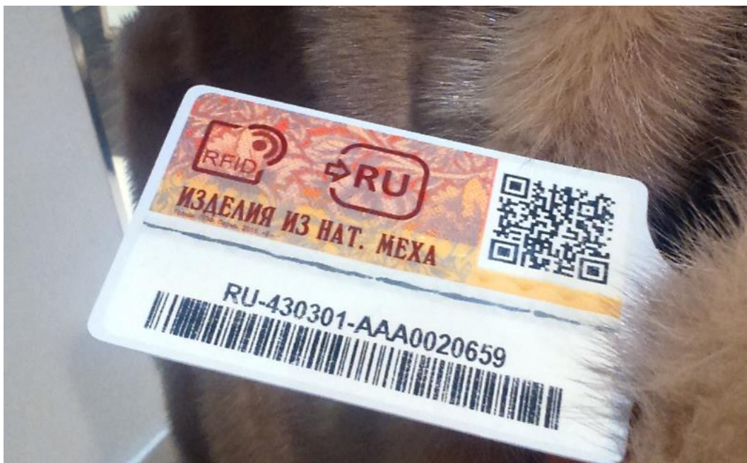
Рисунок 7 – RFID-метка для маркировки товаров
