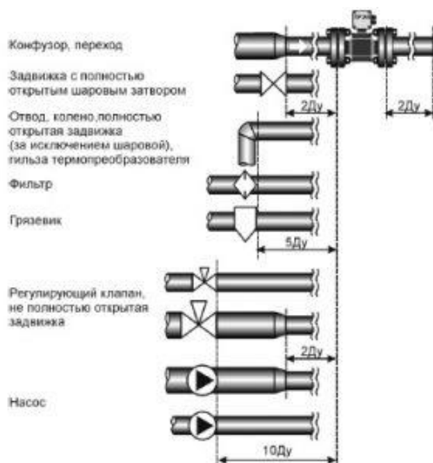
Рисунок 2– Длины прямого участка до и после счетчика–расходомера
