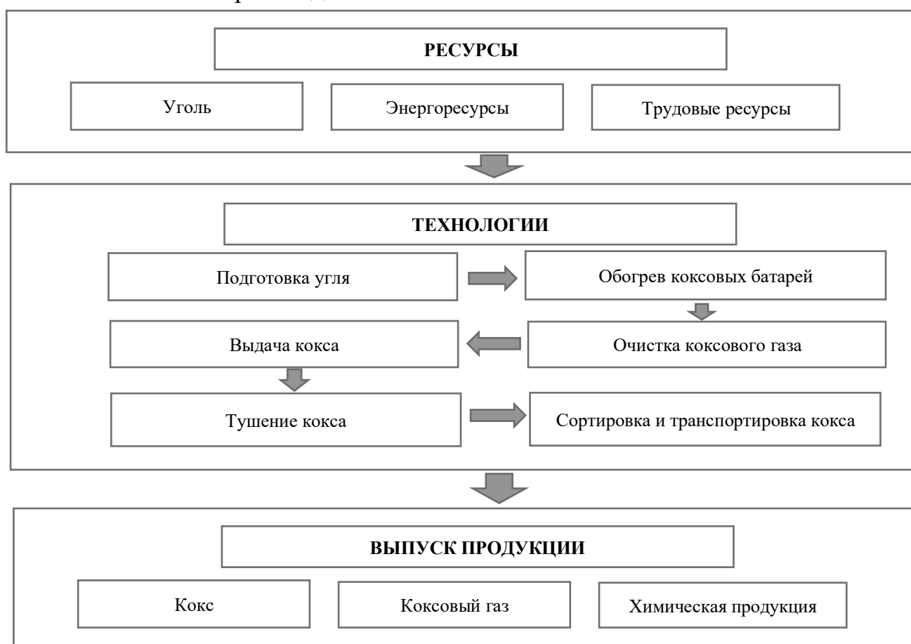
Рисунок 3.1 – Технология производства кокса на ООО «Мечел-Кокс»
