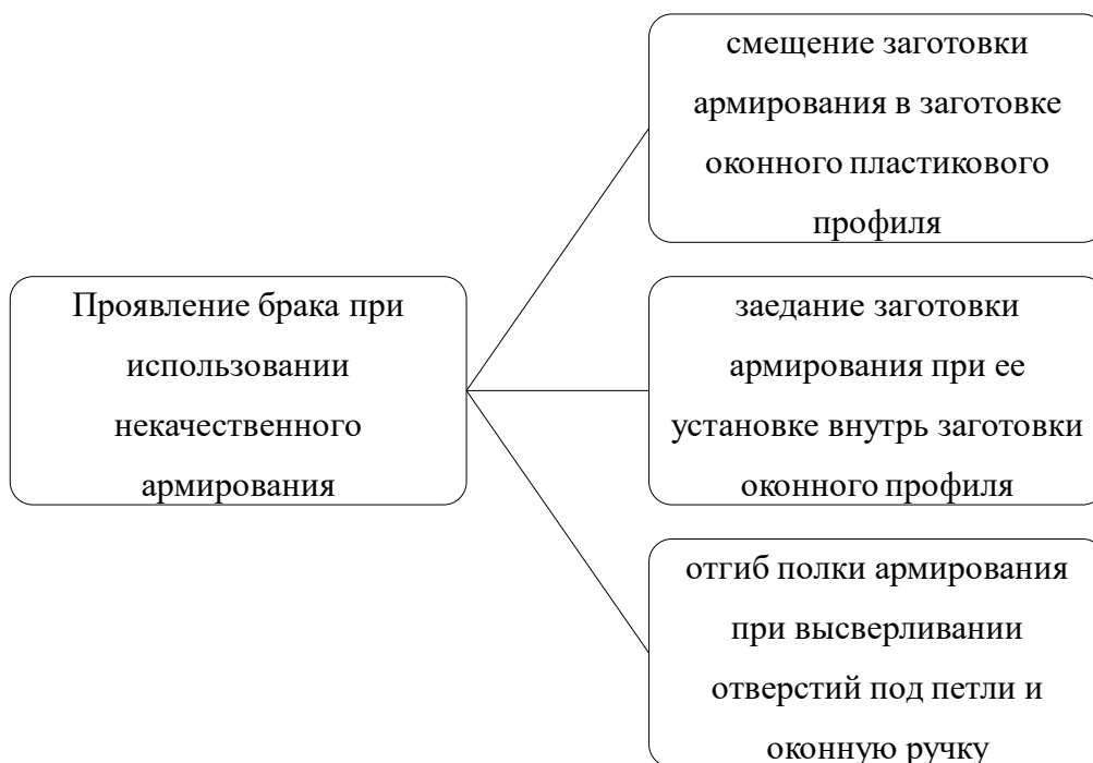
Рисунок 34 – Проявление брака при использовании некачественного армирования
