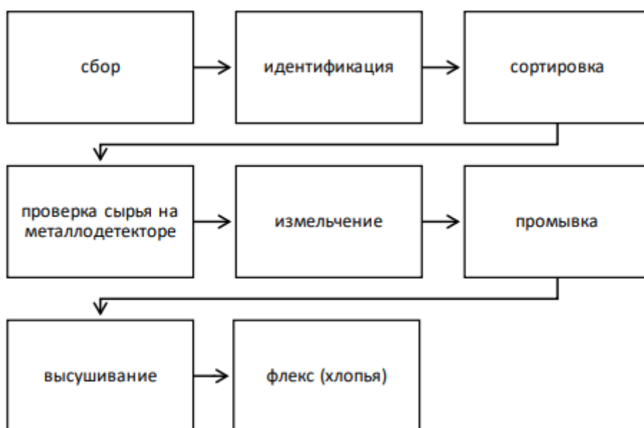
Рисунок 1.18 — Схема механической утилизации отходов пластика
