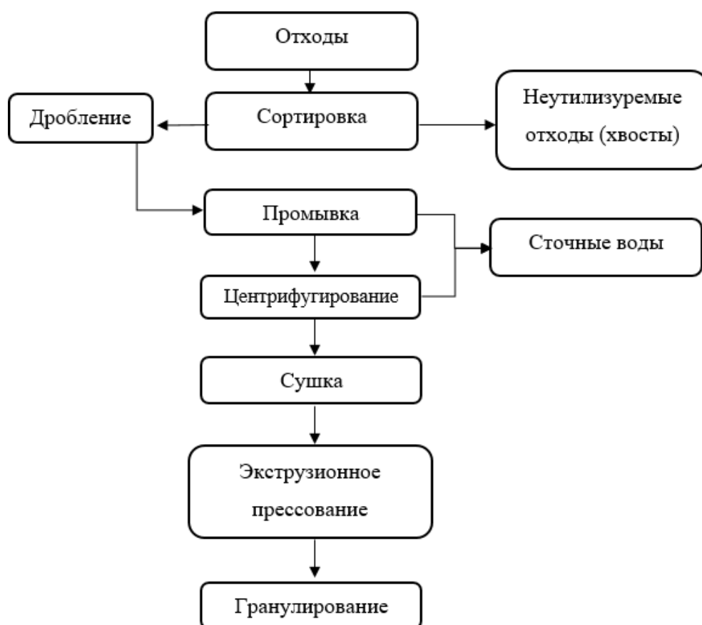
Рисунок 1.19 – Схема переработки отходов ПНД
