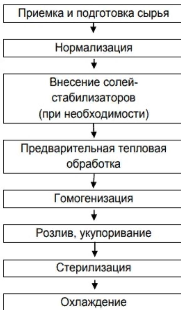
Рисунок 2.2 – Технологическая схема производства сливок
