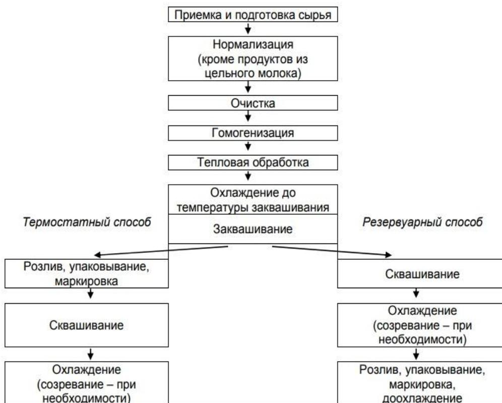
Рисунок 2.4 – Технологическая схема производства кефира
