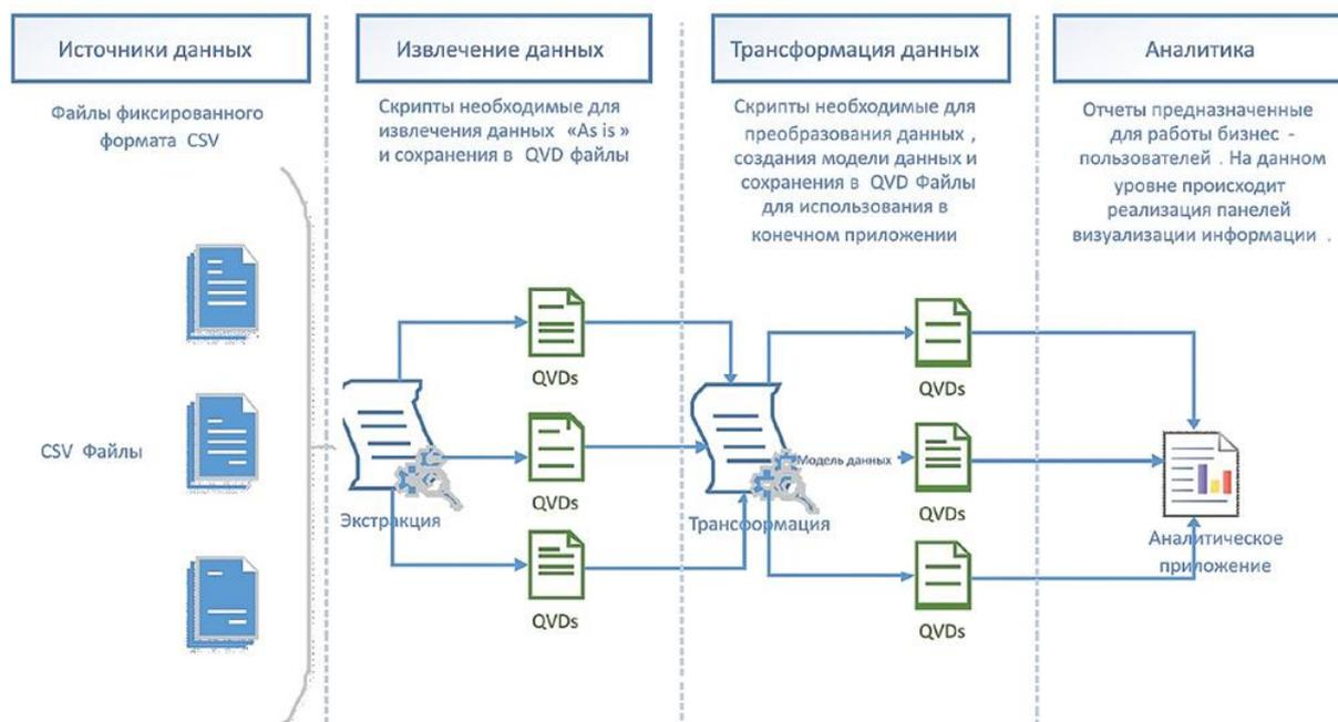
Рисунок 6 – Архитектура системы
