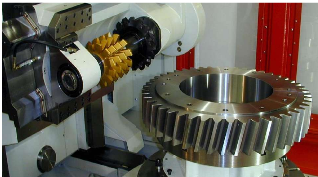
Рисунок 2.7 – Процесс зубофрезерования на станке NGH-180
