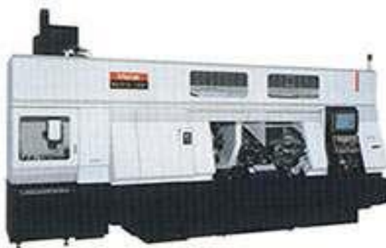
Рисунок 1.4 – Токарный станок с ЧПУ фирмы Mazak серии Multiplex
