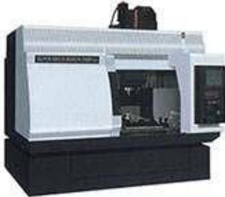
Рисунок 1.8 – Фрезерный станок с ЧПУ фирмы Mazak серии Super Mold Maker
