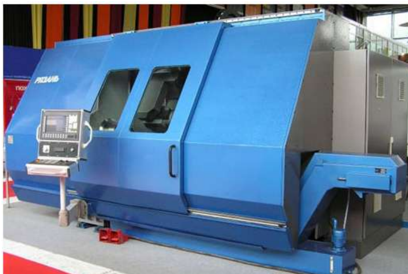
Рисунок 1 – Токарно-фрезерный ОЦ с ЧПУ 1728С
