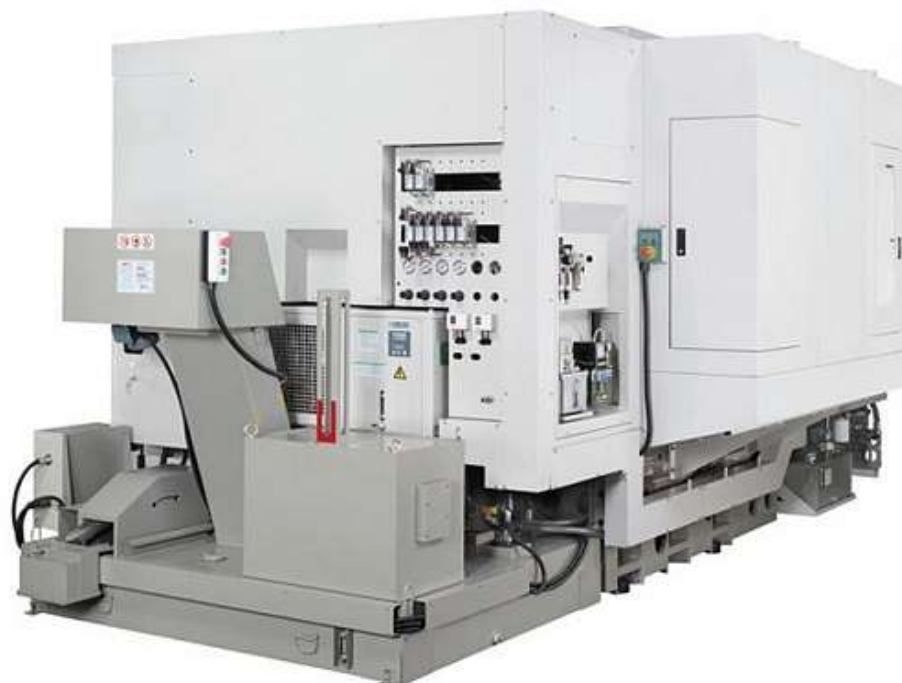
Рисунок 5– Горизонтальный фрезерный обрабатывающий центр с ЧПУ - Victor Vcenter-H400
