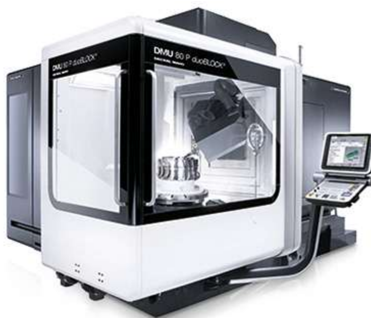
Рисунок 4 – Общий вид универсального обрабатывающего центра с ЧПУ DMU 80P.
