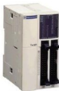
Рисунок 7.1 – Внешний вид ПЛК Twido
