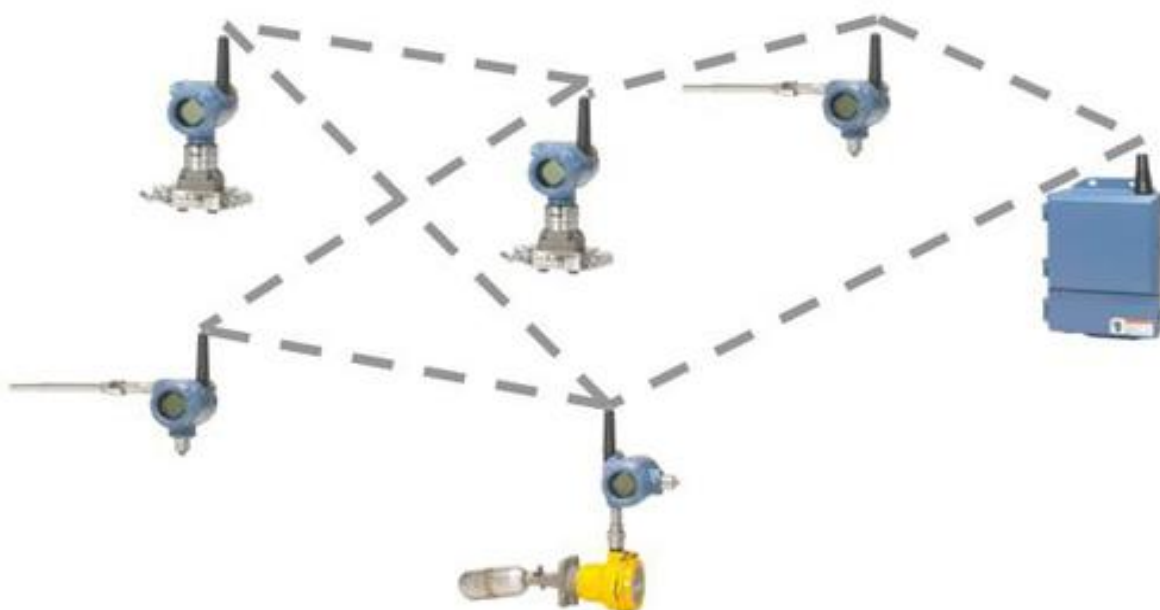
Рисунок 4.7 – Обмен информацией между датчиками и шлюзом
