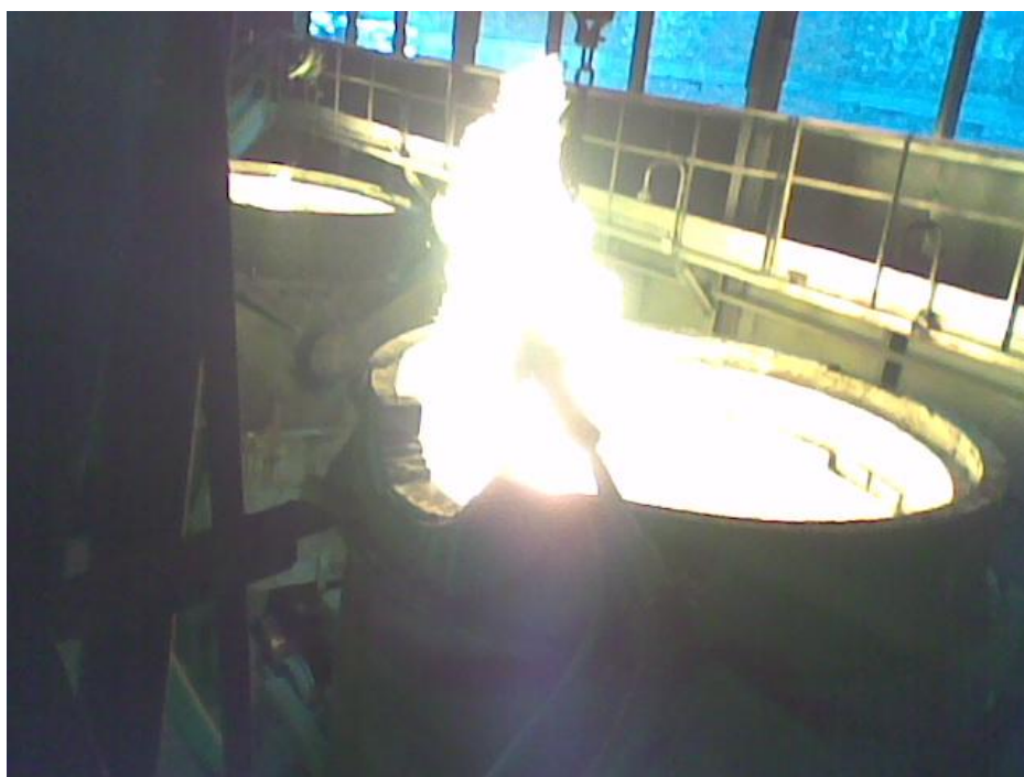
Рисунок 1.4 – Сушка чугуновозного ковша с помощью диффузионной горелки
