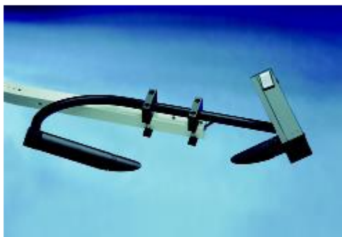
Рисунок 21 – Датчик видимости и осадков
