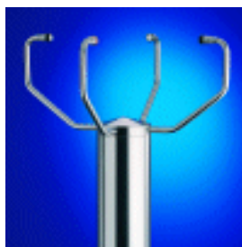
Рисунок 22 – Датчик направления и скорости ветра
