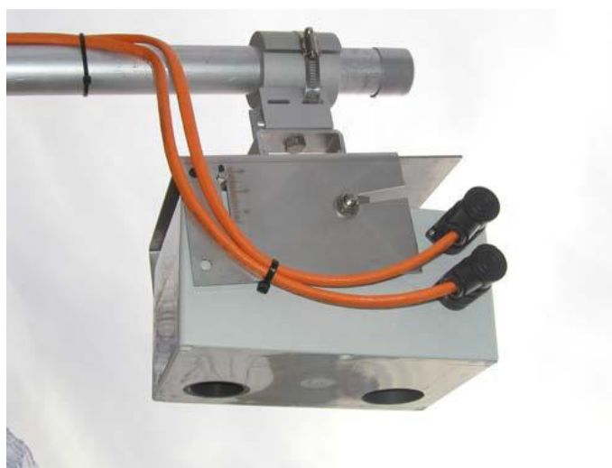
Рисунок 15 – Датчик Triple-tech с крепежными устройствами
