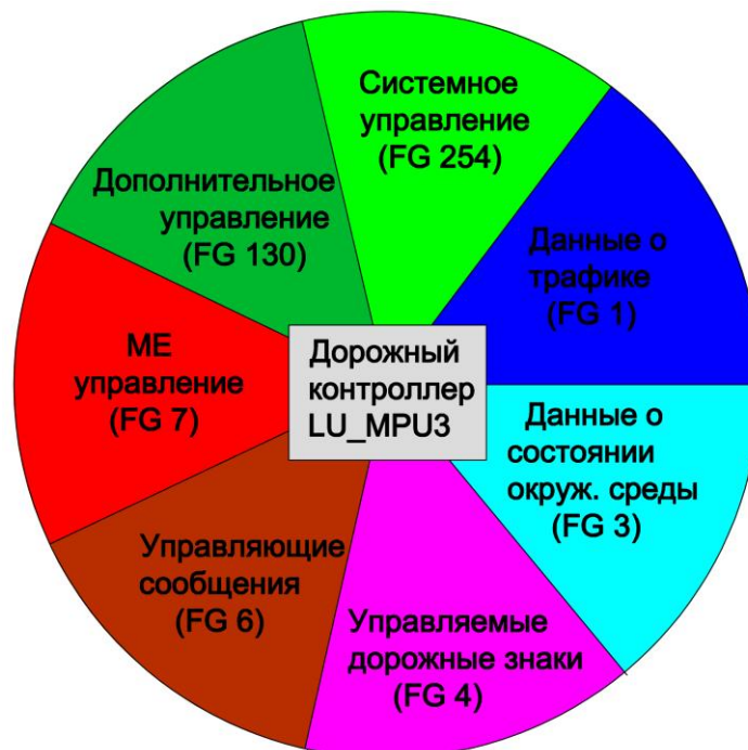
Рисунок 40 – Схема функциональных групп дорожного контроллера
