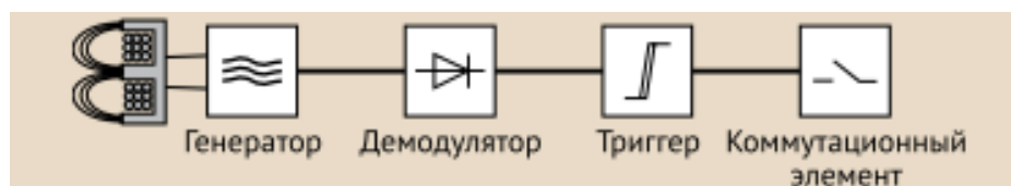
Рисунок 4.5 – Функциональная схема бесконтактного датчика
