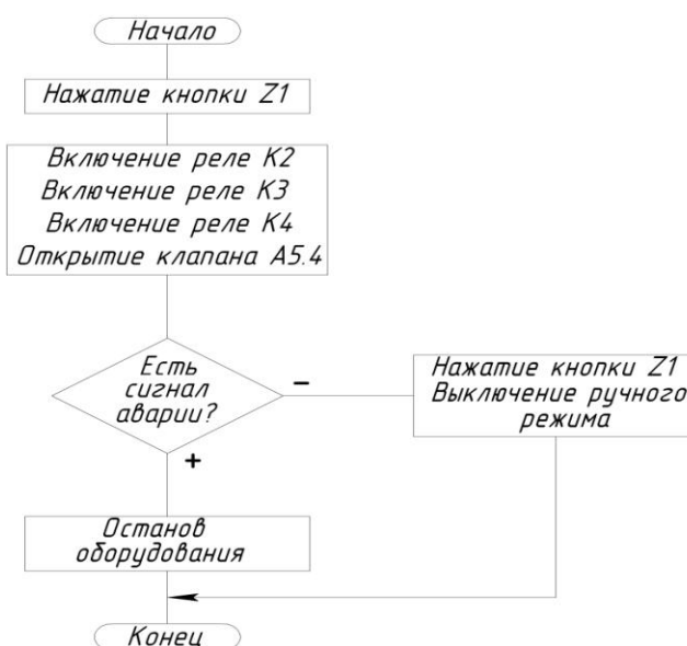
Рисунок 6.1 – Блок-схема работы ручного режима контроллера
